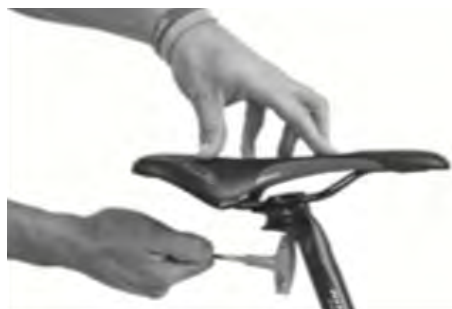
Desserrez les vis d'environ deux à trois tours.
