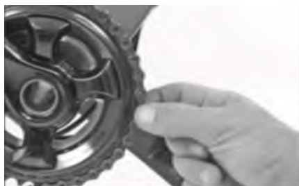
Vérification de l'état de la chaîne.
