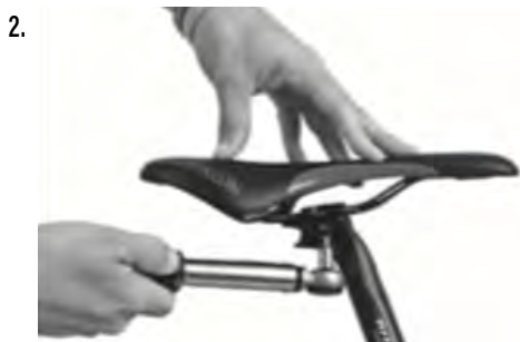
Serrer les deux vis progressivement et alternativement, ne jamais dépasser le couple de serrage maximum autorisé.
